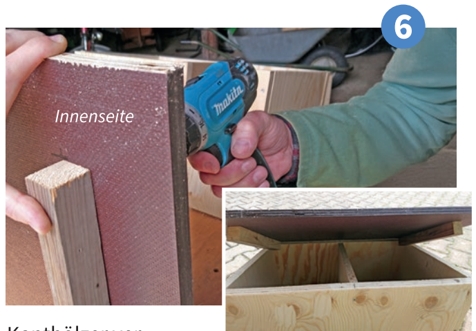
Kanthölzer verschrauben und Dach auflegen
