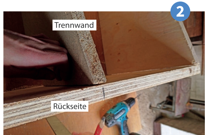
Trennwand an der Rückseite befestigen (mit der Aussparung zur Vorderseite)
